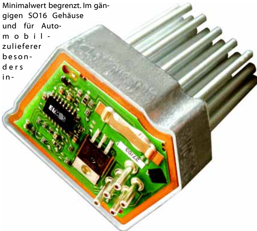
Aufgebautes Modul mit ELMOS Chip (Foto mit freundlicher Genehmigung von Behr Hella Thermocontrol)
